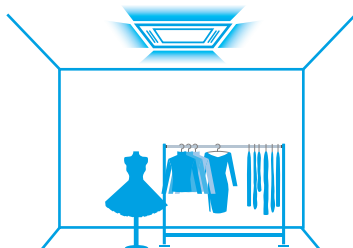
Распределение воздуха чистым фильтром
