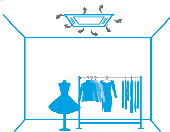
Распределение воздуха грязным фильтром
