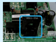
Защита компрессора по току
